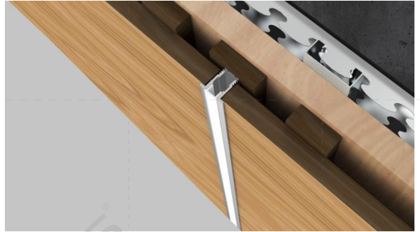
应用案例: 壁装木饰面 开孔:宽 10*深 12mm 玻璃胶固定
